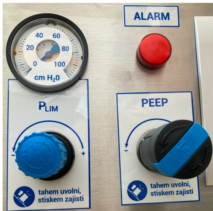
Obr. 12: Otočné ovladače určené k nastavení ventilačních parametrů P_{LIM} (vlevo) a PEEP.
